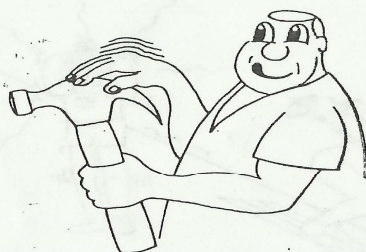
FIGURA 13-6 Aun cuando un trozo de metal y uno de madera se encuentren a la misma temperatura, la pieza metálica parece estar más fría.
